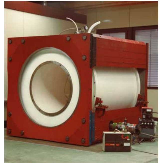
Die Eisenabschirmung verringert das Streufeld des Magneten deutlich, wiegt aber mehr als 30 Tonnen
