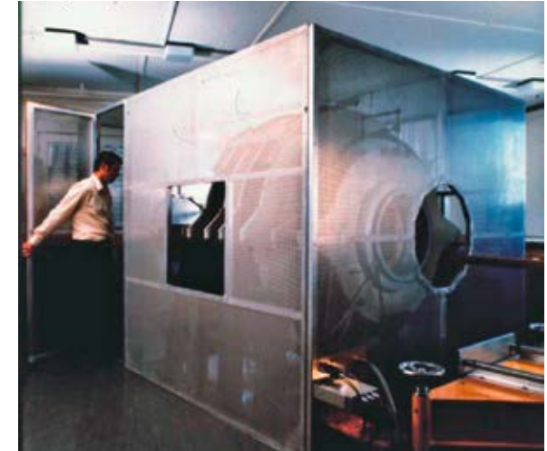
Die Versuchsanlage mit Faraday'schem Käfig zur Abschirmung von Hochfrequenzwellen
