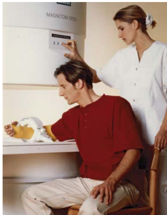
Der Elektromagnet des MAGNETOM Open hat die Form eines stehenden C und ist nach drei Seiten hin offen
