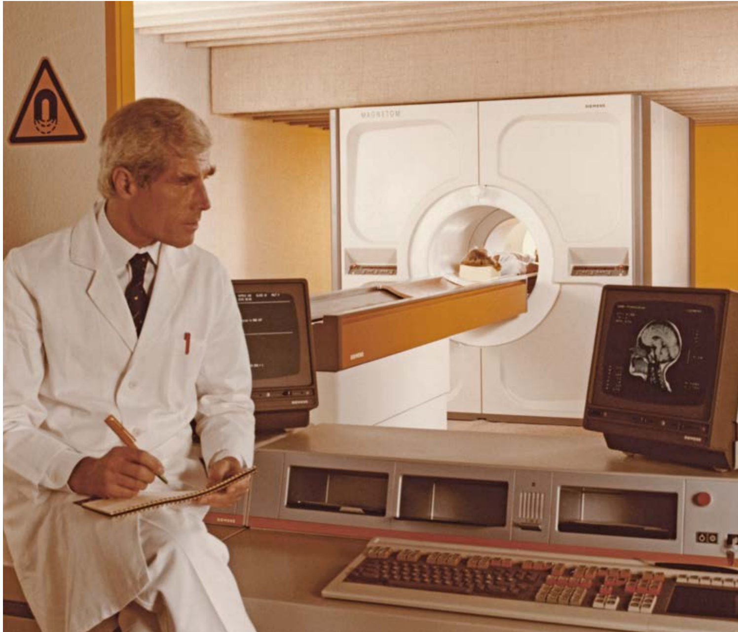
Das 0,35-Tesla-Modell des ersten MAGNETOM wiegt rund 5,3 Tonnen und benötigt mindestens 95 Quadratmeter Raumfläche. Das etwas später folgende Modell mit 1,5 Tesla ist etwa 7,3 Tonnen schwer und nimmt 140 Quadratmeter in Anspruch
