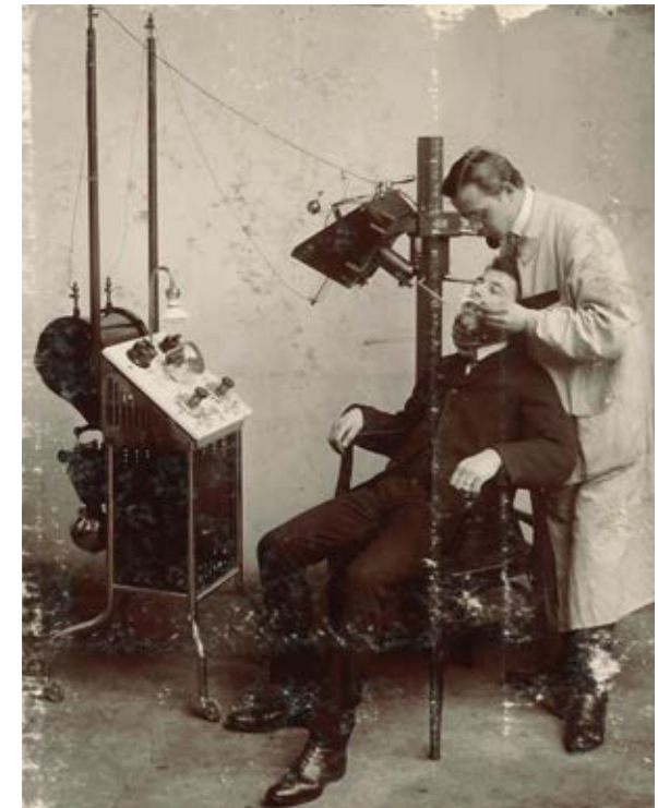
Das Bild dieser zahnärztlichen Röntgeneinrichtung aus dem Jahr 1909 zeigt deutlich, wie nahe Arzt und Patient den offenen Hochspannungsleitungen kommen
