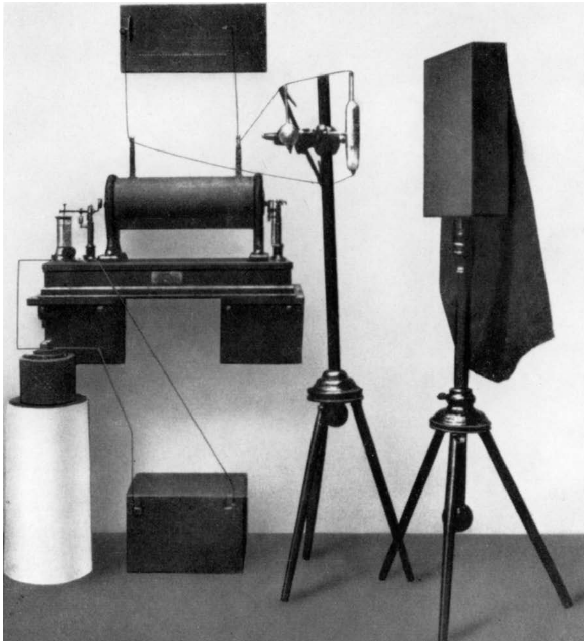
Der erste in Serie produzierte Röntgenapparat von Siemens & Halske, 1897
