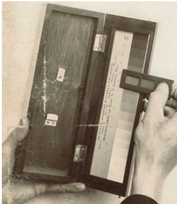
Messung der Strahlenintensität (Dosis) mit dem Quantimeter nach Kienböck, 1905
