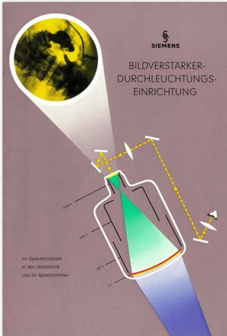
Schematische Darstellung der Funktionsweise eines Bildverstärkers mit Betrachtungsoptik. SRW-Werbedruckschrift, 1958
