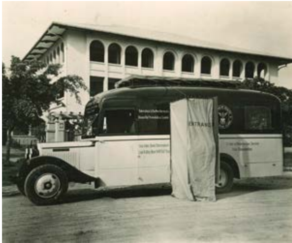
Dieser Bus ist eine „fahrende Röntgenklinik“. Er ist unter anderem mit dem Röntgengerät Orthoskop der Siemens-Reiniger-Werke und einer kompletten Dunkelkammer ausgestattet und in den 1930er Jahren auf den Philippinen im Einsatz
