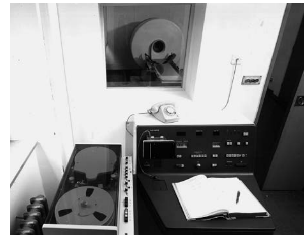
Der Prototyp des SIRETOM mit Magnetspeicher und Polaroid-Aufsatz am Schaltpult, 1974
