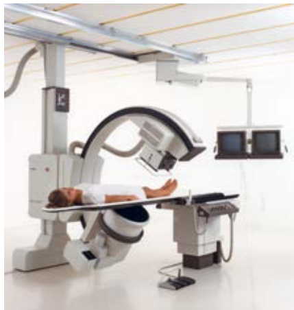
Beim computergesteuerten Siemens Multiskop nimmt der C-Bogen auf Knopfdruck die Untersuchungsposition ein, 1986
