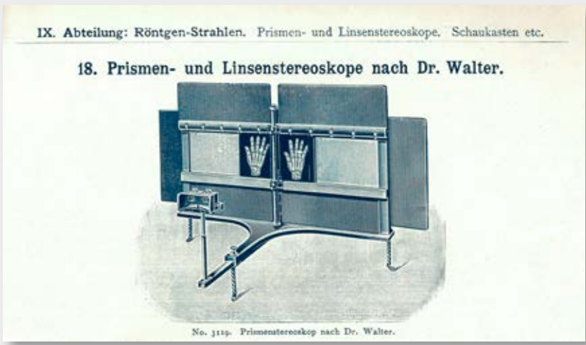
Prismenstereoskop nach Dr. Walter von Reiniger, Gebbert & Schall, Katalog 1905
