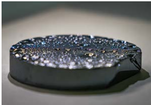
Das Herzstück des quantenzählenden Detektors ist die speziell für die Anforderungen der Computertomographie gezüchtete kristalline Verbindung Cadmiumtellurid.
