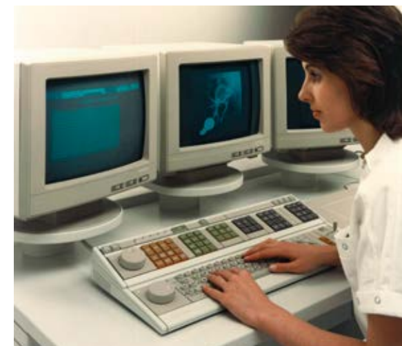
Mit dem POLYTRON 1000 lassen sich ab 1988 alle digitalen Röntgenbilder auswerten
