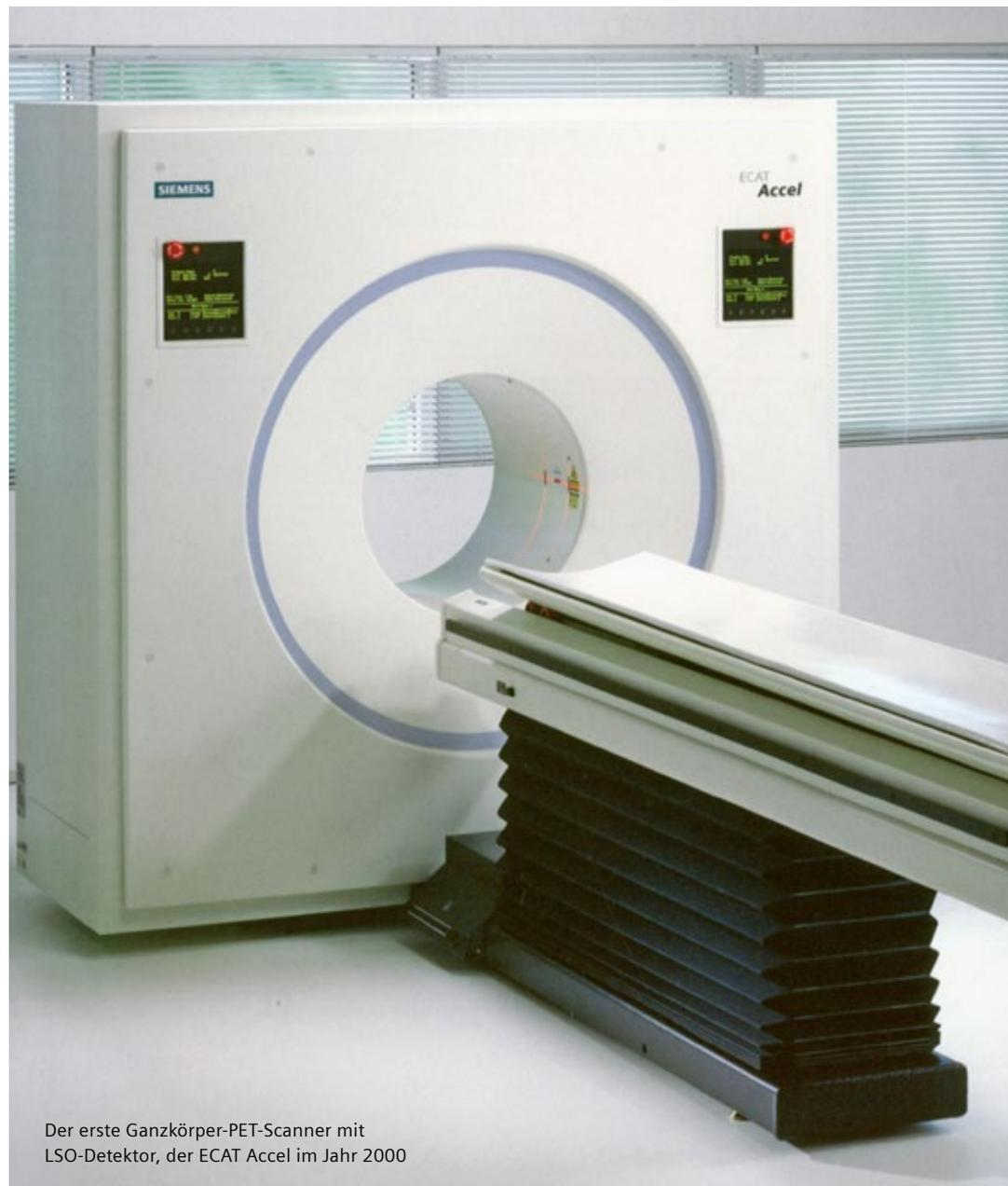
Der erste Ganzkörper-PET-Scanner mit LSO-Detektor, der ECAT Accel im Jahr 2000
