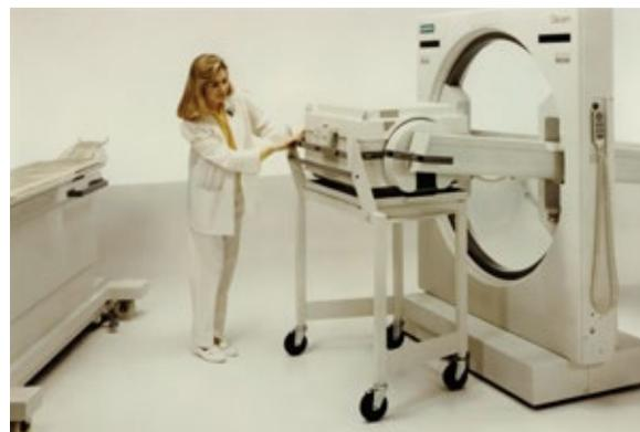
Mit der Wechsel-Technologie der DIACAM lassen sich die bis zu 187 Kilogramm schweren Kollimatoren mühelos wechseln
